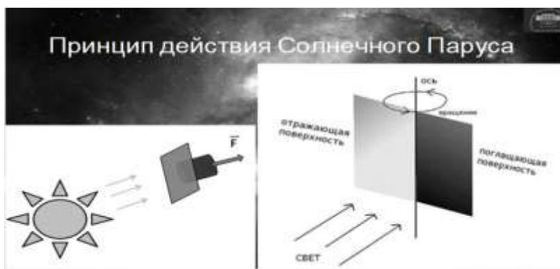
Рисунок 2 – Принцип действия солнечного паруса.
