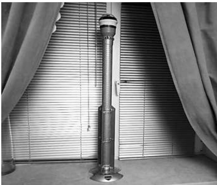
Рисунок 3. Ракетный зонд СВЗ «Пустельга»
