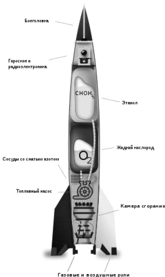
Рисунок 2 – Схема одноступенчатой боевой ракеты с ЖРД «Фау-2»
