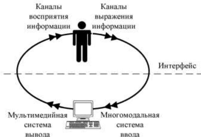
**Рисунок 1.** Обобщенная функциональная схема многомодального человеко-машинного взаимодействия (цит. по [1]).
