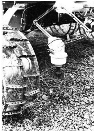
Рис.5 Общий вид 9-ого колеса (а) и пенетromетра (б) ПрОП-а на СШ Лунохода-1
