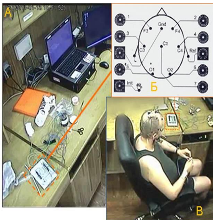
Рис. 1. Методика проведения синхронной регистрации ЭЭГ и УПН.
