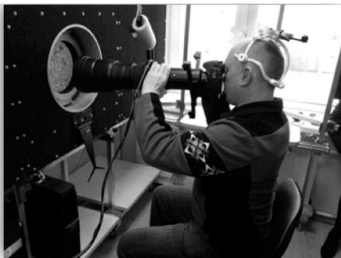
Рис. 7 Тренировки на рабочем месте РМО1 тренажёра «ВИН» с использованием имитатора фотоаппарата
