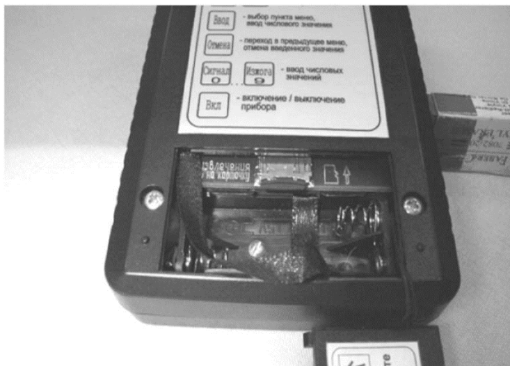
Рисунок 2. Отсек питания и слот для MicroSD-карты
