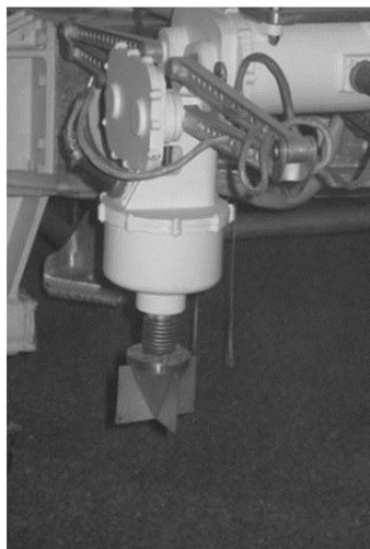
Рис.4 Общий вид штампа пенетromетра ПрОП
