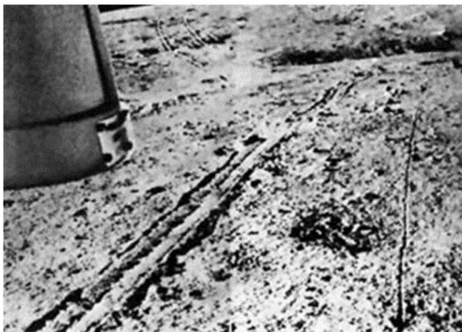
Рис.13 Чёткий след перемещения обода 9-ого колеса по реголитному слою поверхности Луны (через кратер, бугорки и подъём)
