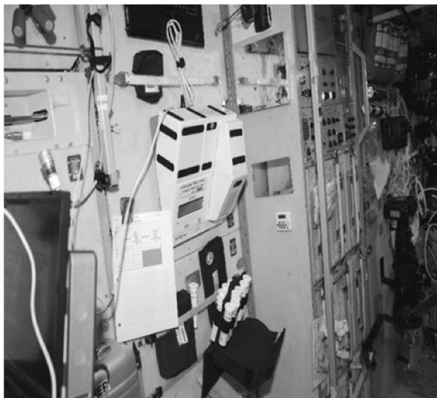
Рисунок 11. Бортовой биохимический анализатор Рефлотрон-4 с комплектом определенных пластин для проведения исследований по программе КЭ "Спланх"
