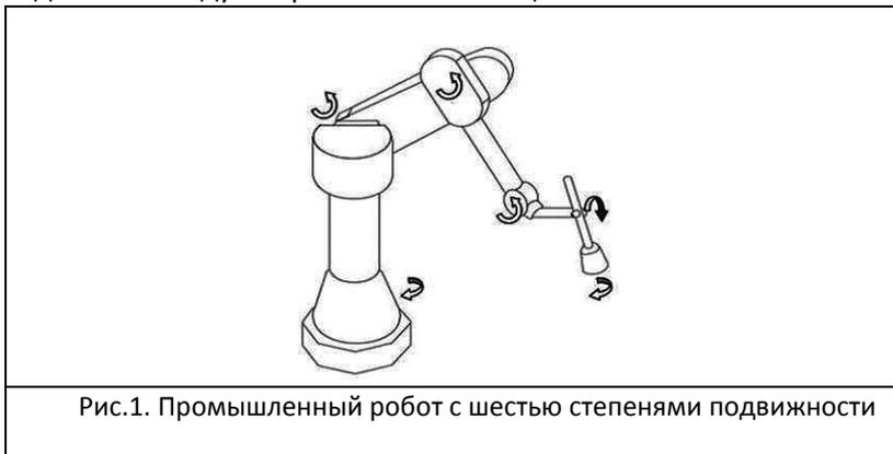
Однако, несмотря на отсутствие сил тяжести, остаются силы инерции. Поэтому при выборе скорости перемещения груза (например, при ручном управлении) необходимо учитывать, что во время разгона/торможения силы инерции могут создавать запредельные усилия на захватном устройстве, что может привести (в худшем случае) к механической поломке конструкции манипулятора или к высвобождению груза.
