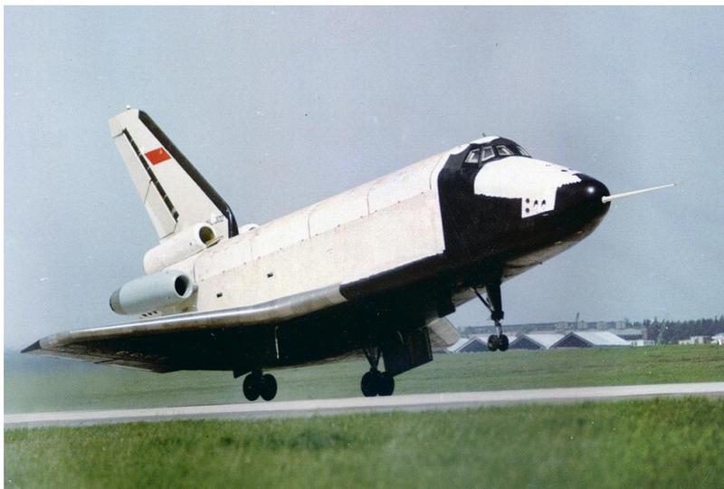
Рис. 3. БТС-002 на взлёте. Хорошо видны удлинённая носовая стойка шасси, ПВД в носовой части, двигатели АЛ-31
