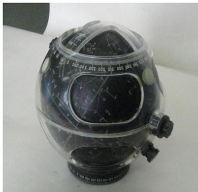
Рис.2. Бортовой звездный глобус БЗГ-1М.
