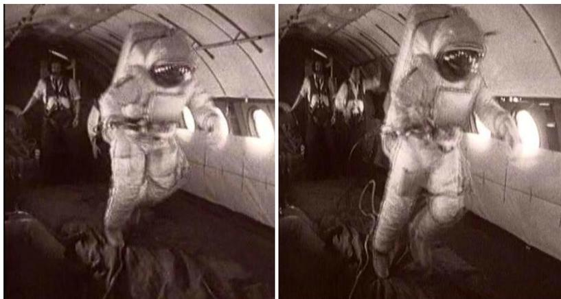
Рис. 4. Тренировки на самолете «Т-104 А» с моделированием лунной гипогравитации ( $1/6 G$ ) с выполнением операций отбора проб грунта в скафандре «Кречент-94»
