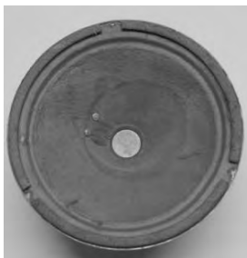
Головка динамическая ИГД-5 для радиовещательных приёмников. (из фондов ФГБУК «Музей- заповедник Ю.А. Гагарина»)
